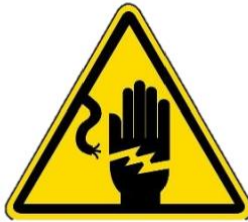
Rambu Bahaya Elektrik
